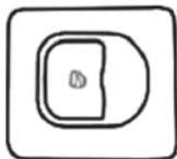
Данная кнопка расположена в водительской двери. Нажатие на нее приводит к блокированию управления задними стеклоподъемниками. Функция рекомендуется для использования, когда на заднем сидении находятся дети.
