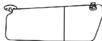
Солнцезащитный козырек предназначен для предотвращения ослепления водителя или переднего пассажира встречным ярким светом. Для этого необходимо повернуть солнцезащитный козырек на нужный Вам угол. Для предотвращения ослепления боковым светом солнцезащитный козырек можно освободить из ближнего к салонному зеркалу зажима и повернуть по направлению к боковому окну.
