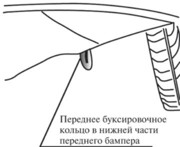
Автомобиль укомплектован буксировочными кольцами, предназначенными для установки буксировочного троса, под передним и задним бамперами.
