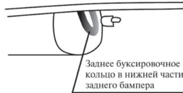
Во избежание повреждения автомобиля или обрыва буксировочного троса избегайте резких замедлений и ускорений. Необходимо, чтобы автомобиль передвигался медленно и плавно, чтобы не допустить рывков буксируемого автомобиля. Чрезмерная сила тяги буксировочного троса может повредить автомобиль.
