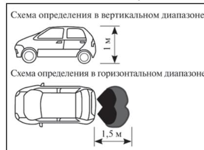
Этот прибор сочетает в себе функции дисплея и звукового оповещения, который расположен внутри автомобиля. При включении задней передачи, радар заднего хода автоматически начинает определять препятствия. При этом, через внутреннее зеркало заднего вида на дисплее станут видны цифры «88» и включится звуковой сигнал.
