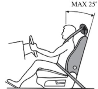
Сидение и спинка кресла должны быть соответствующим образом отрегулированы, чтобы способствовать созданию оптимального защитного эффекта при использовании ремней и подушки безопасности. Нижняя часть спины должна плотно прилегать к спинке кресла. Наклон спинки кресла во время движения не должен превышать 25 градусов. Не придвигайте кресло слишком близко к приборной панели. Во время движения держите руль ненапряженными, слегка согнутыми в локтях руками.
