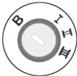
Замок зажигания предназначен для включения электропитания электрооборудования автомобиля, запуска и остановки двигателя, а также фиксации рулевого вала во время стоянки автомобиля.
