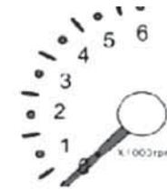
Данный прибор показывает мгновенное значение оборотов коленчатого вала двигателя.
