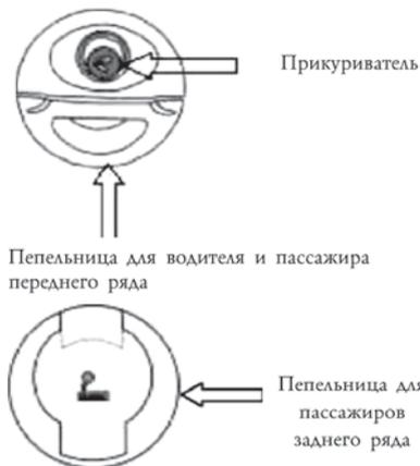
Передняя пепельница – для использования пепельницы нажмите на крышку, лёгким движением потяните за ручку крышки до упора. Не следует прилагать чрезмерные усилия.
