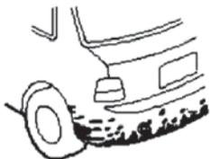
При следующих условиях звук сигнала может отключиться:
