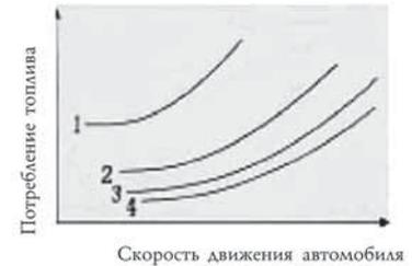
Приведенный выше график иллюстрирует влияние скорости автомобиля и выбранной Вами передачи на потребление топлива Вашим автомобилем. Вождение автомобиля на низкой передаче с высокой скоростью, а также с частыми ускорениями и торможениями ведет к значительному росту расхода топлива, а также быстрому износу деталей и частей автомобиля.
