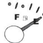
Емкость топливного бака Вашего автомобиля составляет 48 литров. Когда стрелка указателя уровня топлива находится на отметке «E» (положение, показанное на картинке) это говорит о том, что топливный бак пуст. Отметка «F» указателя означает, что топливный бак полон.
