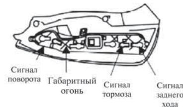
Если одна из ламп заднего фонаря вышла из строя, замените её согласно приведённой ниже инструкции.
