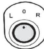
Наружные зеркала заднего вида, установленные на Вашем автомобиле, оснащены электроприводом регулировки их положения. Электропривод управления зеркалами работает только если ключ зажигания находится в положении II. Регулировка положения
