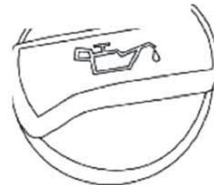
При низком уровне масла в двигателе долейте свежее масло до отметки щупа MAX. Чтобы открыть крышку маслозаливной горловины, поверните ее против часовой стрелки. Не открывайте крышку маслозаливной горловины при работающем двигателе.
